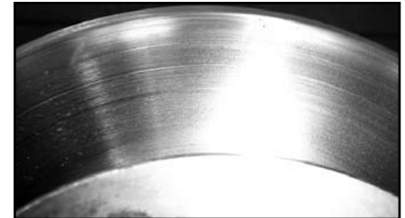
Fig. 47 - Superaquecimento na pista de frenagem
