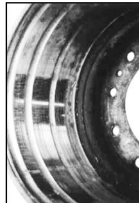
Fig. 26 - Desgaste causado por rebite
