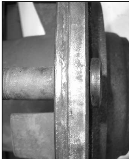
Fig. 56 - Face de montagem danificada.
