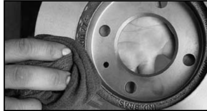
Fig. 42 - Retirando o verniz do disco de freio
