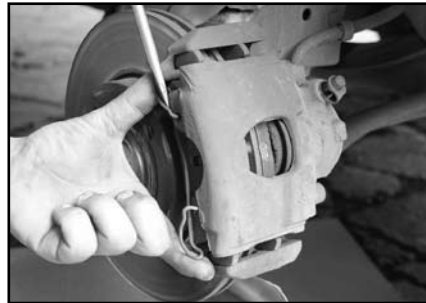
Fig. 36 - Remoção da trava
