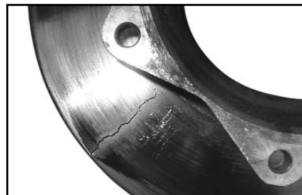
Fig. 44 - Trinca na pista de frenagem
