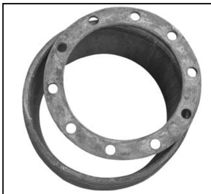
Fig. 25 - Trinca de flange
